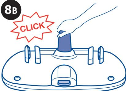
8. Ajuste la correa rígida de la entrepierna a la charola (diagrama 8A, diagrama 8B). El diseño del aditamiento de la correa de la entrepierna sólo permite un tipo de operación de montaje. Ahora la charola se puede colocar a la silla de comer.
