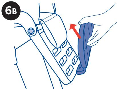
6. Inserte el reposapiés, gírelo hasta alcanzar la posición de uso, y atórelo en su lugar (diagrama 6A). El reposapiés se puede ajustar a 3 posiciones. Quite el reposapiés y ajústelo a la altura deseada (diagrama 6B y 6C). Gire el reposapiés hasta obtener la posición de uso deseada y atórelo en su lugar.
